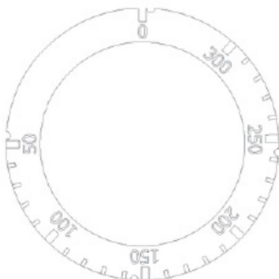
Schalten Sie den Schalter an der Vorderseite des Geräts ein. Drehen Sie den Drehknopf von "0" auf die gewünschte Position zwischen 50° und 300°C, die weißen und grünen Kontrollleuchten leuchten auf
